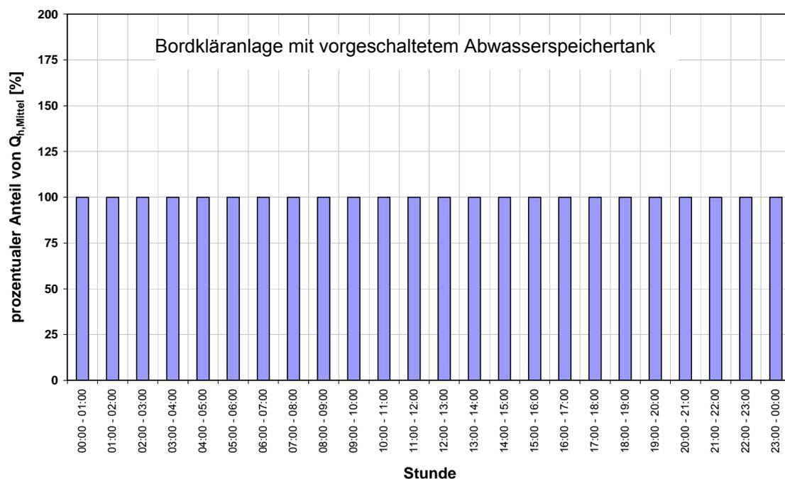
Abbildung 1: Tagesganglinie der Bordkläranlagen-Beschickung mit vorgeschaltetem Abwasserspeichertank
