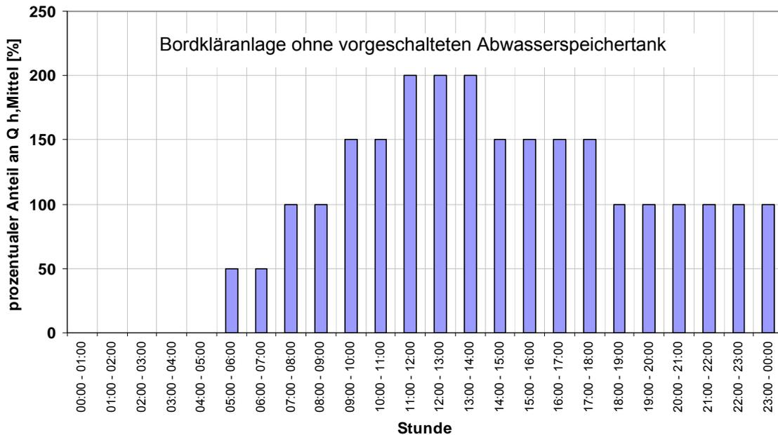
Abbildung 2: Tagesganglinie der Bordkläranlagen-Beschickung ohne vorgeschalteten Abwasserspeichertank
