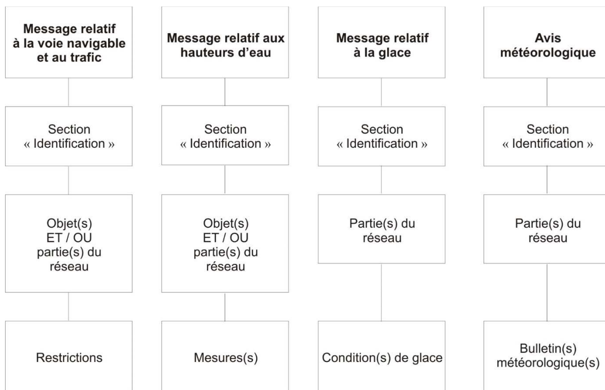
Figure III-1 Structure des avis à la batellerie
